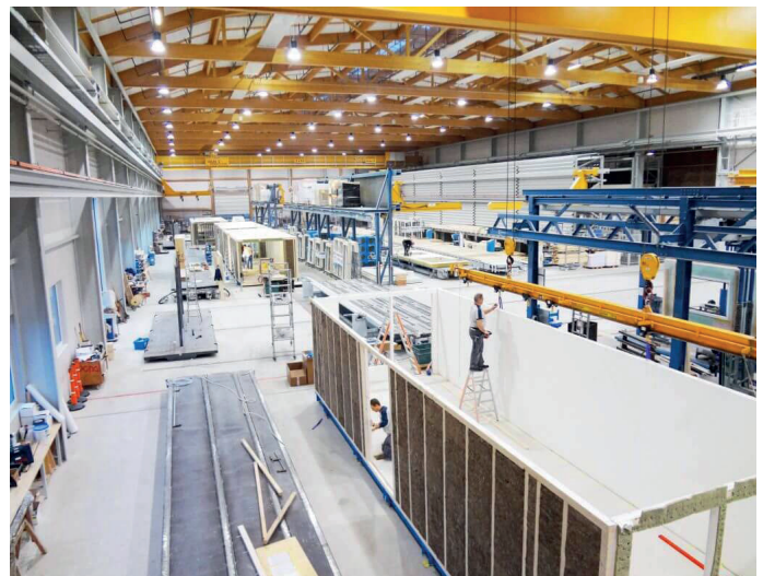
Holzmodulbau (3D): Produktion vom Raummodulen im Werk der Renggli AG Schoetz
